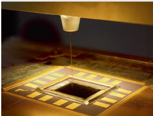
**3** Проверка прочности внутренних соединений
