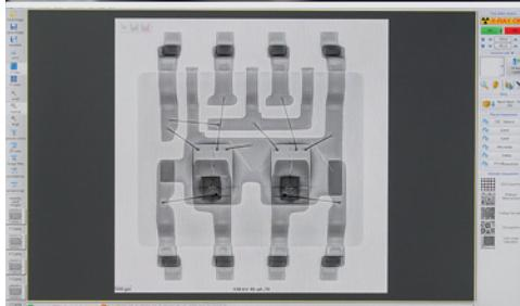
**13** Неразрушающий контроль качества внутренних элементов конструкции
