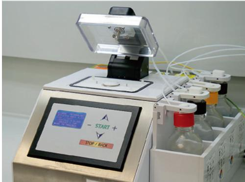
**5** Декорпсирование ЭКБ в пластмассовых корпусах, в том числе с сохранением работоспособности
